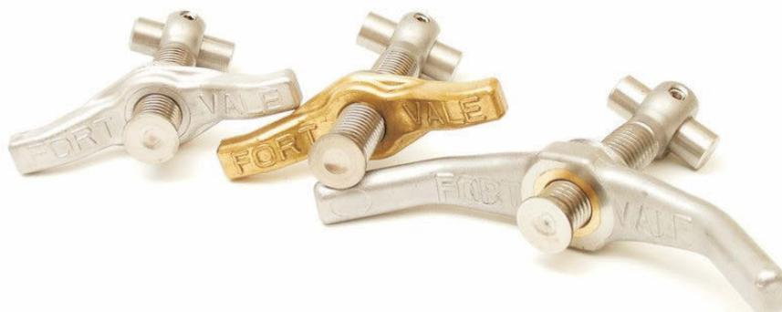
Augenbolzen mit 16mm oder 3/4" Öhr (Dimension A) x 3/4"BSW (Dimension B) x Länge von der Öhrmitte bis zum Bolzenende (Dimension C). Hergestellt aus Edelstahl mit M8 Gewindestiften. Geliefert mit Knebelschraubenscharnierbolzen und genuteter Handmutter (siehe Tabelle für Optionen)
